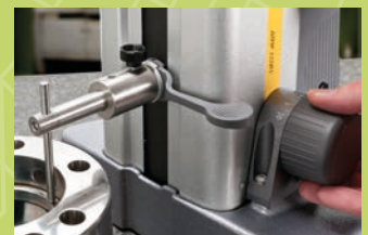
Měření hloubky osazení
