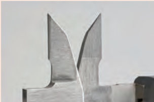
Měřicí čelisti osazené tvrdokovem
