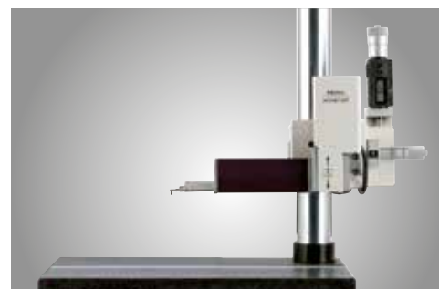
Volitelná samostavitelná jednotka, jednotka nastavení osy X a digitální vyrovnávací jednotka montované na žulový stojan.
