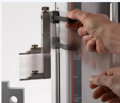
III. 1. Posuňte měřicími saněmi rukou ve směru měření.
